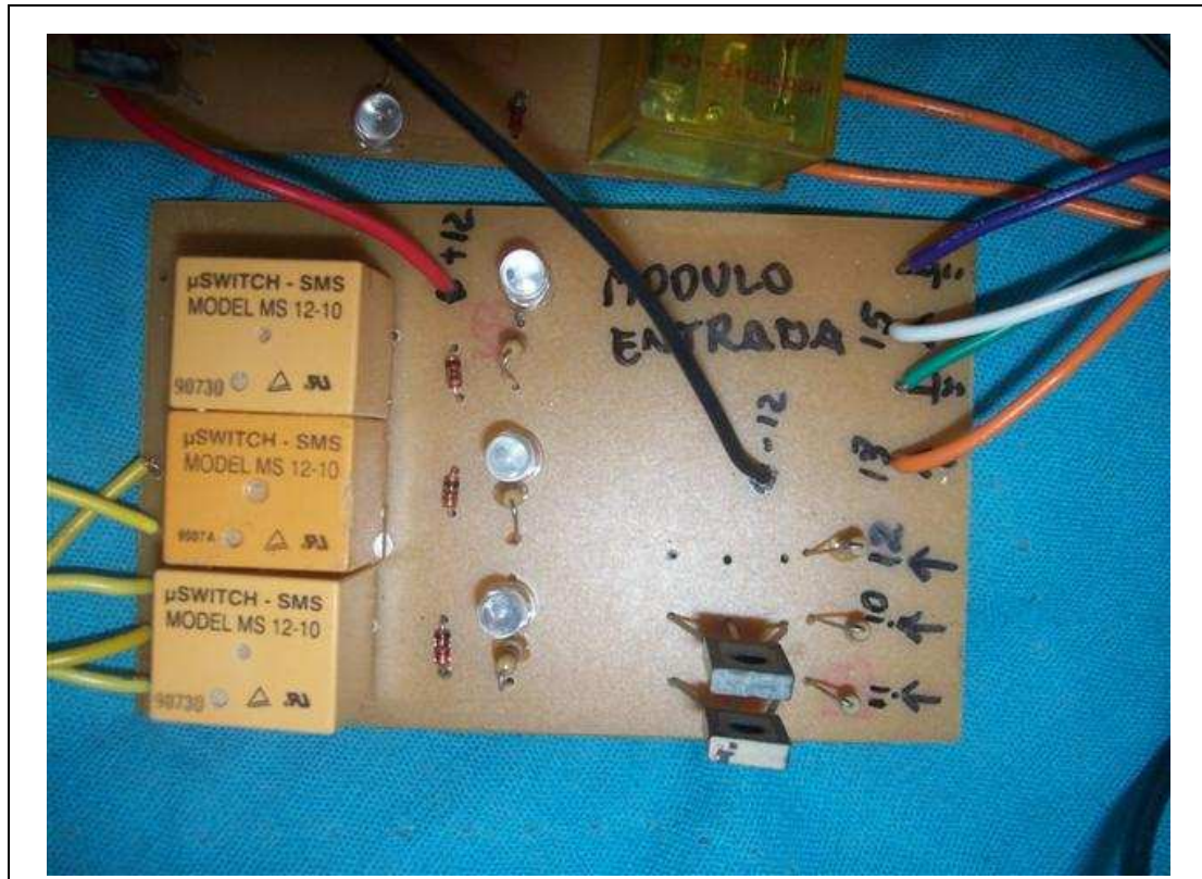
Figura 5.10. Placa de Circuito Impresso Módulo de Entrada: Lado dos componentes.
