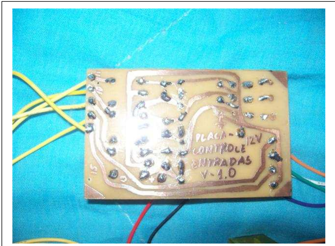
Figura 5.11.Placa de Circuito Impresso Modulo de Entrada: Lado cobreado.
